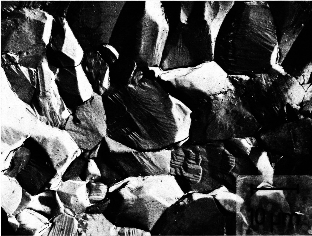
Abb. 1. Pflastersteinstruktur beim polykristallinen Selen. Oberfläche einer 1500 min lang bei 212 °C getemperten Probe aus Reinstselen.
