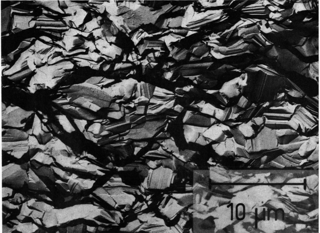
Abb. 3. Bruchfläche einer 20 min lang bei 142 °C und 5 min lang bei 212 °C getemperten Probe aus thalliumdotiertem Selen.
