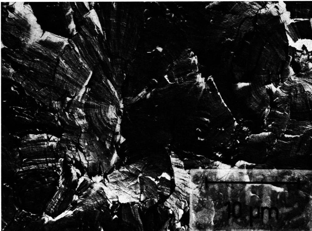
Abb. 2. Bruchfläche einer 20 min lang bei 142 °C und 5 min lang bei 212 °C getemperten Probe aus chlordotiertem Selen.
